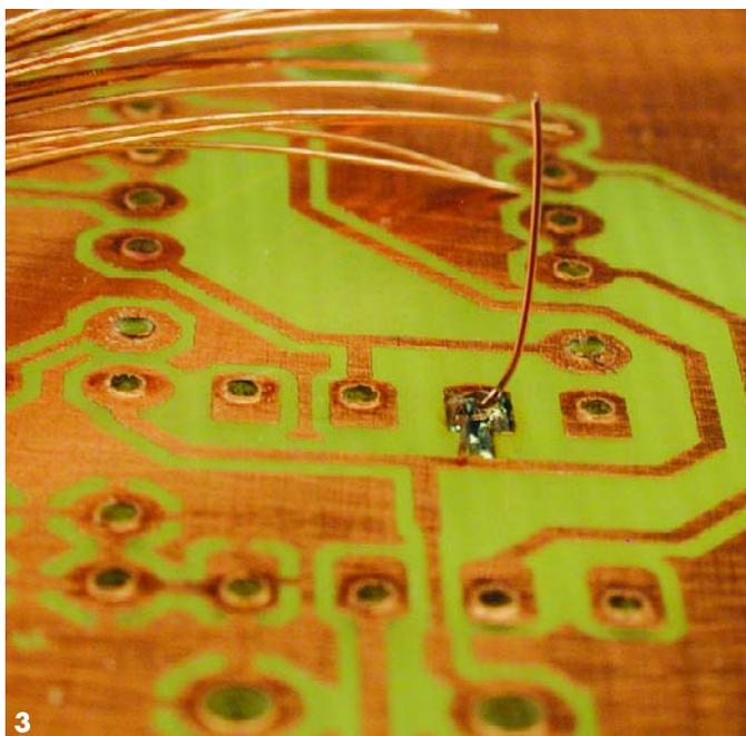
ritus gereinigt. Wenn man danach die betroffene Platinen-Stelle mit Lötlack einsprüht, sind die blank liegenden Kupferbahnen gegen Umwelteinflüsse geschützt, und beim späteren Wiederaufbau der Schaltung fließt das Lötzinn besser.
