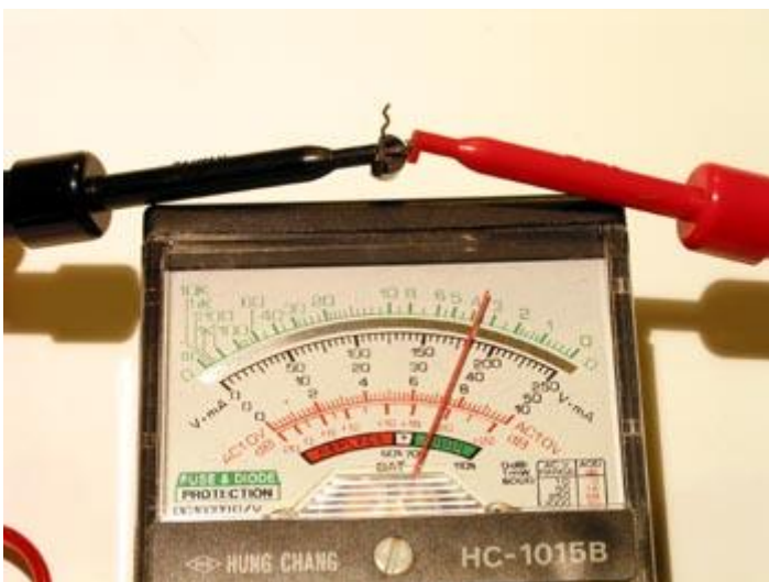
Prüfung des Durchgangs mit dem "x10k"-Widerstandsmeßbereich zwischen Basis (rot, plus) und Kollektor (schwarz, minus) eines npn-Transistors
