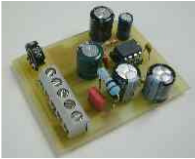
Der kleine Bruder: IC TBA820, 2 Watt mono
