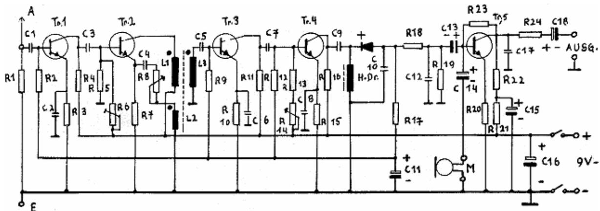
**Halbleiter:** T1...T4 = npn-Hochfrequenztransistoren mit hoher Grenzfrequenz, Typen etwa BF 194 o.ä., in der Niederfrequenzstufe als Transistor T5 die Type BC 147 o.ä. Als HF-Diode D1 eine Germaniumdiode AA 116 o.ä.
